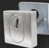
SCHUTZROSETTENPAAR SQUARE 52 X 52 MM MIT KERNZIEHSCHUTZ inkl. Befestigungsmaterial - M5 Zylinderüberstände: 10 - 17 mm Höhe außen: 14 mm/innen: 10 mm TST 68 - 72 mm Farbe: Edelstahl matt
