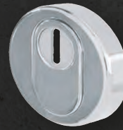
SCHUTZROSETTE AUSSEN MIT KERNZIEHSCHUTZ Schrauben M5 Zylinderüberstände von 10-17 mm Rosettenhöhe: 14 mm Farbe: Edelstahl matt
