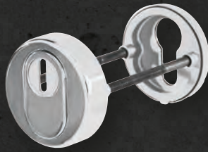
SCHUTZROSETTENPAAR Ø 55 MM MIT KERNZIEH- SCHUTZ inkl. Befestigungsmaterial - M5 Zylinderüberstände von 10-17 mm Höhe außen: 14 mm/innen: 9 mm TST 68 - 72 mm Farbe: Edelstahl matt
