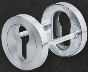
SCHUTZROSETTENPAAR Ø 52 MM, OPTIK DER 3-TLG. SCHRAUBROSETTE inkl. Befestigungsmaterial - M5 Höhe außen: 8 mm/innen: 8 mm TST 68 - 72 mm Farbe: Edelstahl matt
